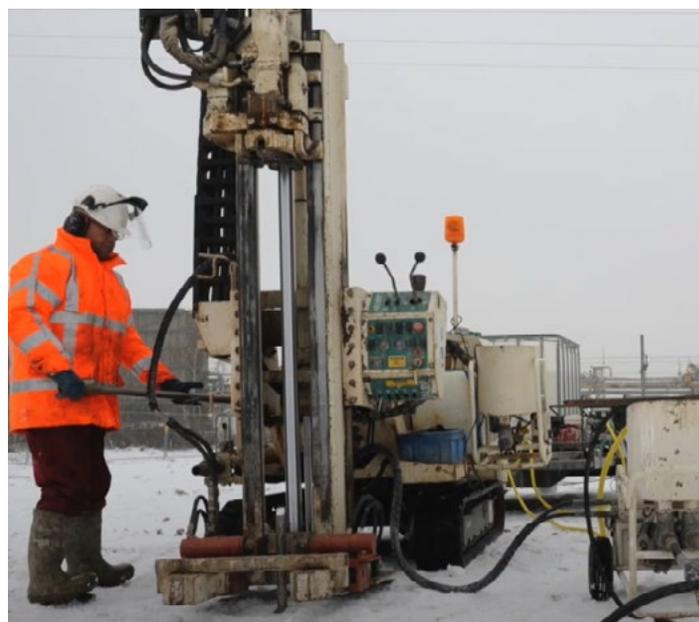
Figure 1. Injection « direct push » de 3DME
