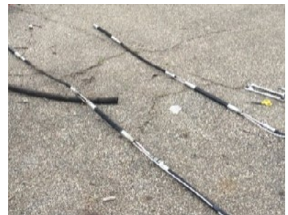
Fig.5: Tubería de punto fijo con válvulas (arriba) y obturadores inflables dobles para inyección de punto fijo con válvulas (abajo)
