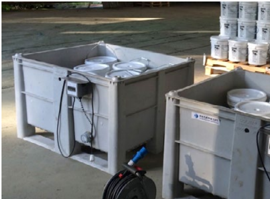
Fig. 1: Fustini di HRC in bagno di riscaldamento
