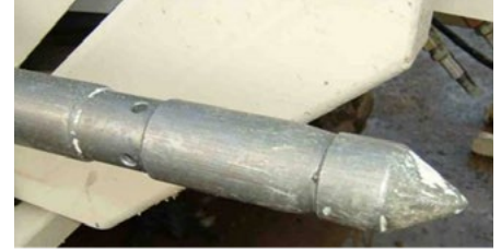
Fig. 6: Punta attivata a pressione
