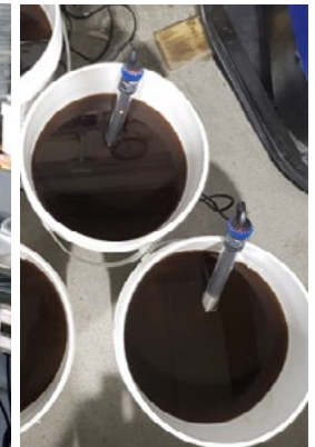
Fig. 2: Riscaldatori individuali all'interno dei fustini HRC
