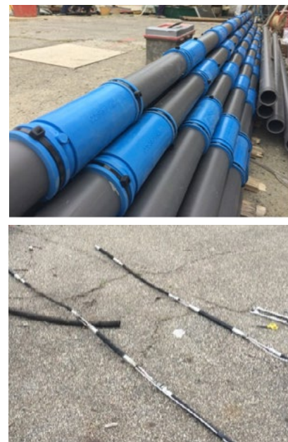
Fig. 8: Tubazioni per postazione fissa valvolata (sopra) e doppi packer per iniezione in postazione fissa valvolata (sotto)
