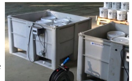
Fig. 1: Fustini di prodotto in bagno di riscaldamento
