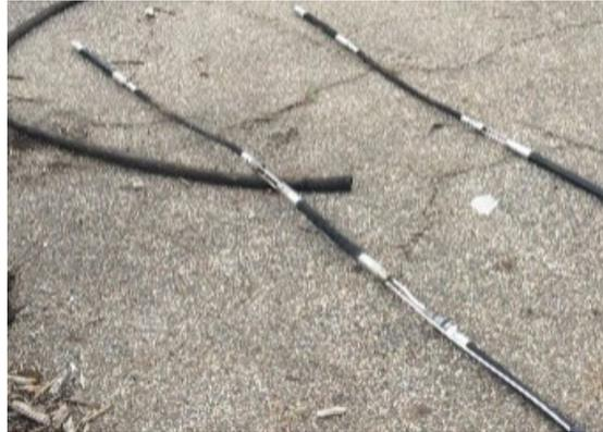
Fig.4: Tuberías para puntos fijos con válvulas (izquierda) y obturadores inflables dobles para inyección en puntos fijos con válvulas (derecha)
