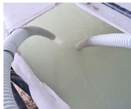
Fig. 1 PersulfOx dans la cuve de mélange. Les équipements utilisés sont en matériaux chimiquement résistants.
