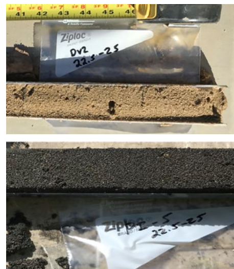
En haut, une carotte de sol prélevée avant l'application de PetroFix. En bas, une carotte de sol prélevée après l'application de PetroFix, montrant une coloration noire attestant d'une distribution efficace de PetroFix.
