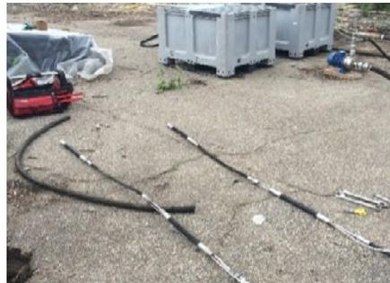
Fig. 6: Tuberías para puntos fijos con válvulas (izquierda) y obturadores inflables dobles para inyección en puntos fijos con válvulas (derecha).
