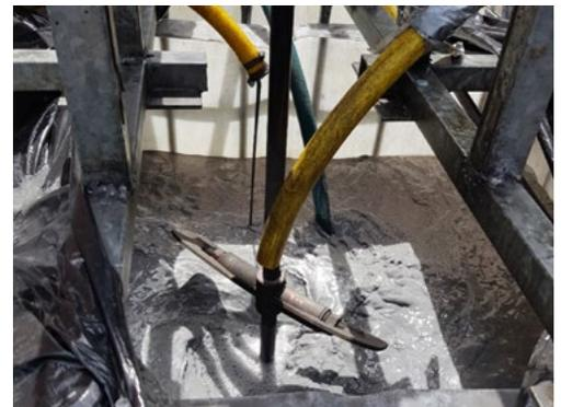
Fig. 3: Adición de S-MicroZVI al tanque de mezcla con la mezcla 3DME ya formada.
