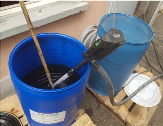
Fig. 1: Barril con S-MicroZVI concentrado y bomba de extracción de barriles (drum pump).
