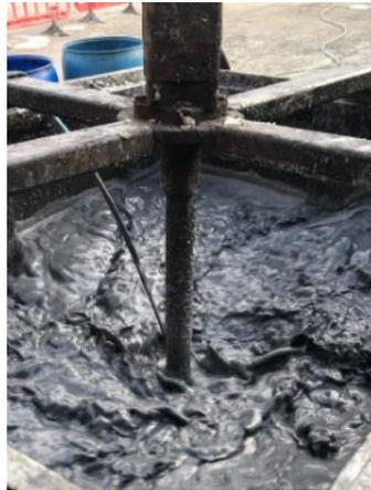
Fig. 2: Tanque de mezcla con S-MicroZVI.
