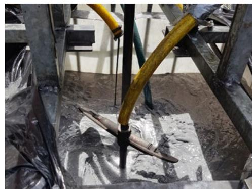
Fig. 3 Aggiunta di S-MicroZVI nella vasca di miscelazione con miscela 3DME già formata
