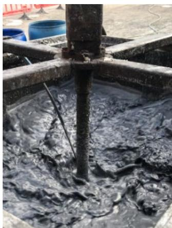
Fig. 2 Vasca di miscelazione con S-MicroZVI.
