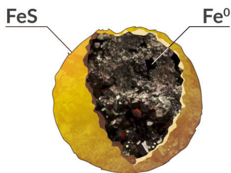
Figure 1 : S-MicroZVI est constitué de particules ZVI qui sont recouvertes de sulfure de fer.
