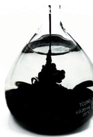
Bild 2: Verteilung von PlumeStop im Erlenmeyerkolben
