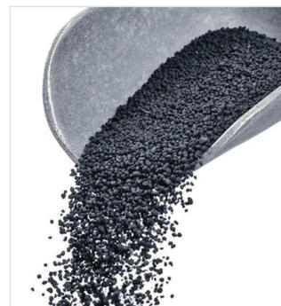
SourceStop Solid wird *in situ* oder *ex situ* mit einem Standardbagger/ Bodenmischgerät in die Böden gemischt. Es ist so konzipiert, dass es staubarm ist und sich leicht handhaben lässt. Wenn es gemischt wird, zerfällt das Verbundkomposit schnell und beschichtet die Böden mit aktivierter Kohle. Die kolloidale Aktivkohle wird freigesetzt, was die Verteilung und Penetration verbessert, um die Mischzeit zu verkürzen und eine effektive Behandlung zu gewährleisten.
