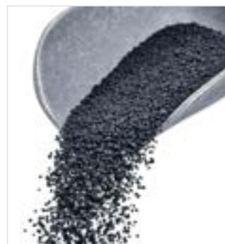
SourceStop Solid viene miscelato ai terreni *in situ* o in cumulo utilizzando attrezzatura standard per soil mixing o escavatore. È progettato per essere poco polveroso e facile da maneggiare. Una volta miscelato, il composito aggregato si disintegra rapidamente rivestendo i terreni con carbone attivo. Il carbone attivo colloidale viene rilasciato, potenziando la distribuzione e la penetrazione, riducendo i tempi di miscelazione e assicurando un trattamento efficace.
